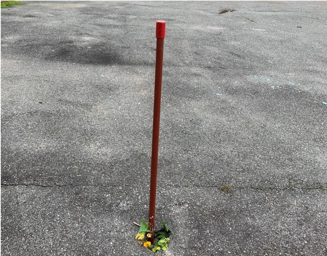
Figur 11: Ett av befintliga installerade grundvattenrör
