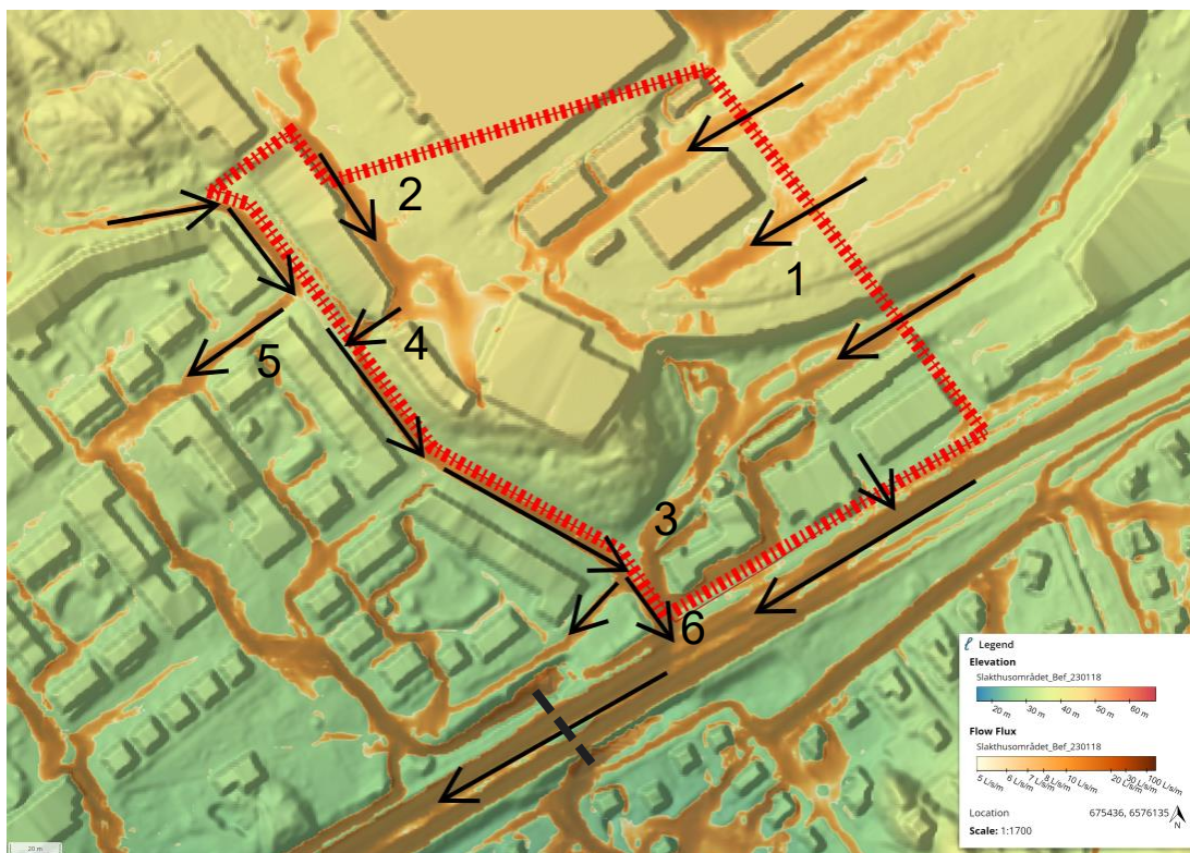
Figur 9 Avrinningsvägar vid befintlig situation in och ut ur detaljplanegränsen för Dp 3. Siffror hänvisar till markeringar i tillhörande textstycke. Svarta pilar indikerar generell flödesriktning och streckad svart linje läge för gc-passage under Enskedevägen. Nyanser av orange indikerar olika storlekar på flödet, större flöden vid mörk nyans.
