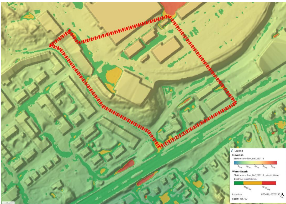
Figur 10 Maxvattendjup vid befintlig situation inom och runt om detaljplanegränsen för Dp 3. Vattendjup enligt följande; grön = 0,05-0,2 m, gul = 0,2-0,5 m, röd = >0,5 m
