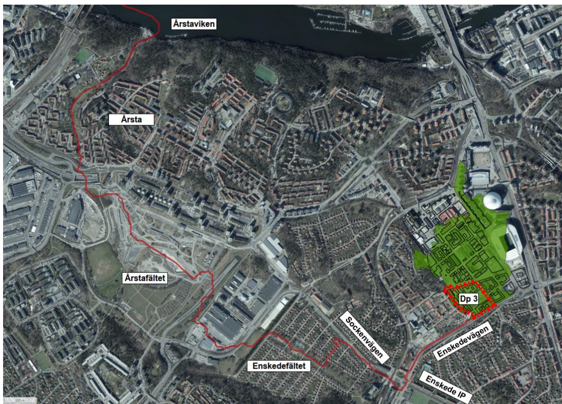
Figur 2 Avrinningsområde Södra Slakthusområdet (grön markering) och dess avvattning i riktning mot Årstaviken (svagare röd linje). Baseras på befintlig situation. Planområdesgräns Dp 3 i röstreckad linje. Källa: SCALGO Live, 2023-01-30
