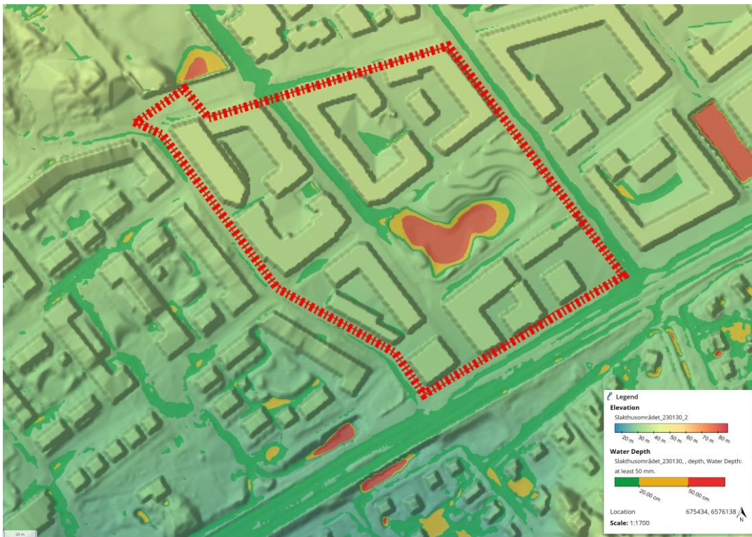
Figur 12 Maxvattendjup vid framtida situation inom och runt om detaljplanegränsen för Dp 3. Vattendjup enligt följande; grön = 0,05-0,2 m, gul = 0,2-0,5 m, röd = >0,5 m
