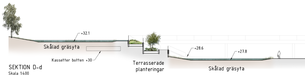
Figur 5:3. Skyfallsterrassen, den övre till vänster och den nedre till höger. Skyfallsterrassernas gräsytor utformas med delar som är djupare för att ytorna ska kunna rymma mer vatten (Urbio, 2022).
