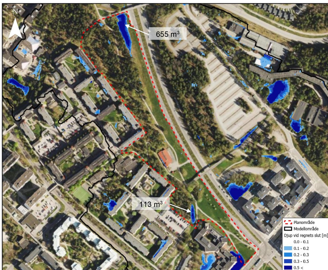
Figur 6:3. Stående vatten för befintliga förhållanden efter 1 timme regn och ytterligare 5 timmar rinntid. Inom planområdet ansamlas en stor mängd vatten i lågpunkterna i planområdets södra och norra delar.
