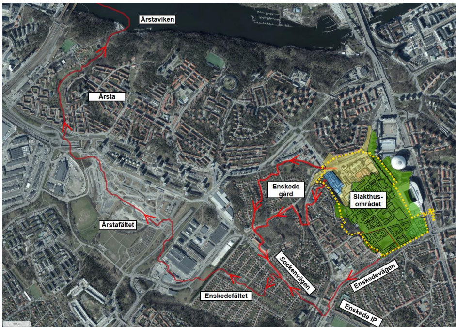
Figur 2 Avrinningsområde Södra Slakthusområdet (grön markering), Norra Slakthusområdet (gul och blå markering) och deras respektive avvattningsriktning i riktning mot Årstaviken (svagare röd linje med pilar för flödesriktning). Baseras på befintlig situation och utgör teoretiska avvattningsvägar där respektive lågpunkt längs sträckan fylls och överskrids. Programområdesgräns i gulstreckad linje. Källa: SCALGO Live, 2023-01-30
