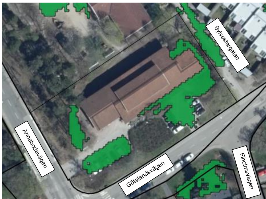
Figur 3. Befintliga lågpunkter inom fastigheten Jullovet 1 enligt Scalgo Live.
