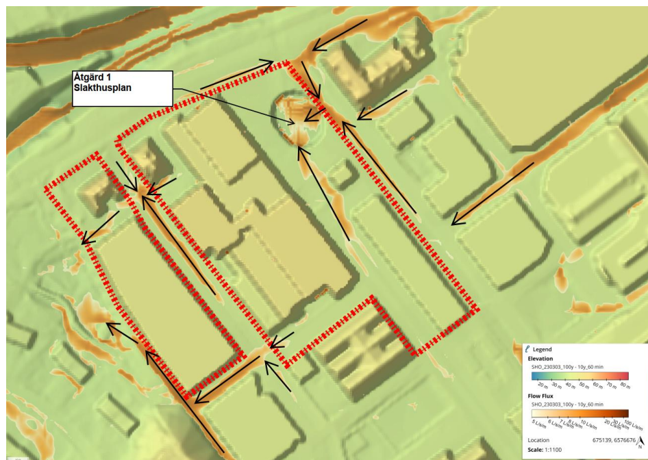
Figur 19 Planerad skyfallshantering inom Dp 5a. Tjocka, svarta pilar visar på flödesriktning. Nyanser av orange indikerar olika storlekar på flödet, större flöden vid mörk nyans.
