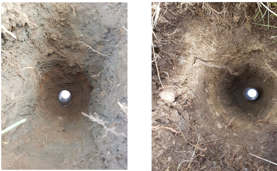
Figur 6 Installation av radonmätare i mätpunkt "Burk 1" t.v. och "Burk 3" t.h.
