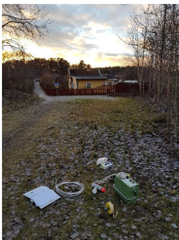
Figur 5: Rens- och omsättningspumpning i grundvattenrör 18GA04 samt 18GA03.
