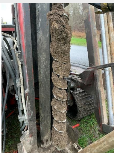
Jordprovtagning under V48 år 2020. Djup 0 - 1 meter. Vanligt förekommande jordlagerföljd över undersökningsområdet.
