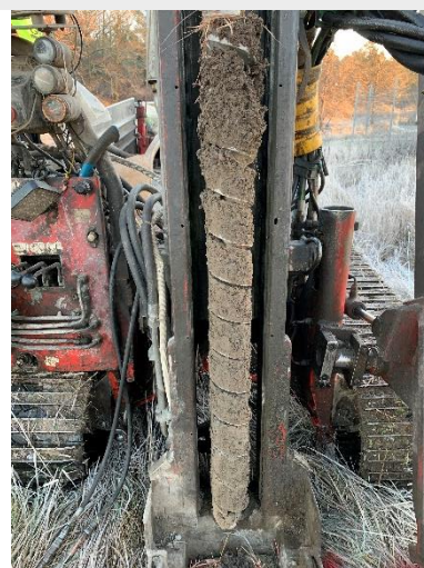
Jordprovtagning under V48 år 2020. Djup 0 - 1 meter. Vanligt förekommande jordlagerföljd över undersökningsområdet.
