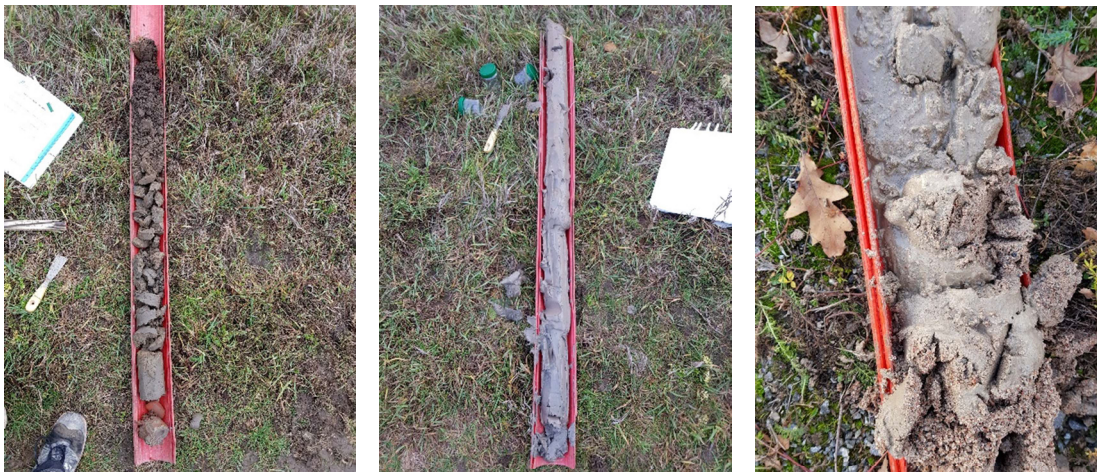
Figur 4: T.v torrskorpelera i provpunkt 18GA20, i mitten fuktig grålera i provpunkt 18GA20, t.v friktionsjord i provpunkt 18GA04. Provtagning med rotonsonic.
