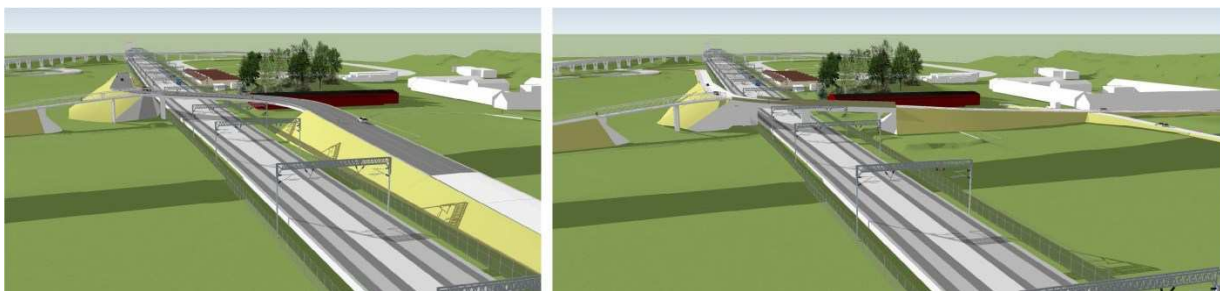
Illustrationer av möjliga brolösningar för planskild korsning vid Sulkylvägen. Till vänster S-formad bro och till höger L-formad bro. Ramp för gång- och cykeltrafik syns till vänster i båda bilderna. Illustrationer: Trafikverket.
