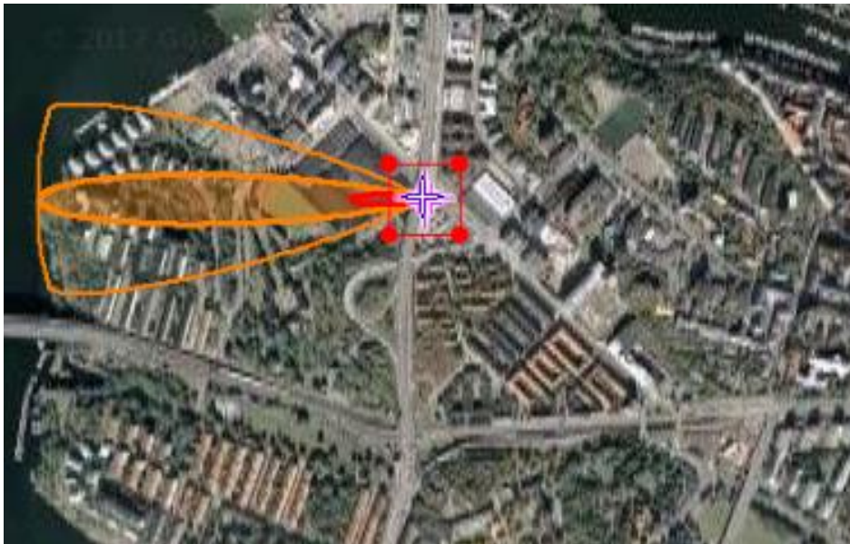
Figur 25. Resultat från utförda spridningsberäkningar av ett utsläpp av tryckkondenserad ammoniak, utsläpp av hela tankens innehåll inom 10 min (mycket stort utsläpp). Röd zon (27 x 179 m) åskådliggör ytor utomhus där människor efter 5 minuters exponering kan omkomma medan orange zon (128 x 953) åskådliggör ytor utomhus där människor efter 5 minuters exponering kan förväntas behöva akut vård.
