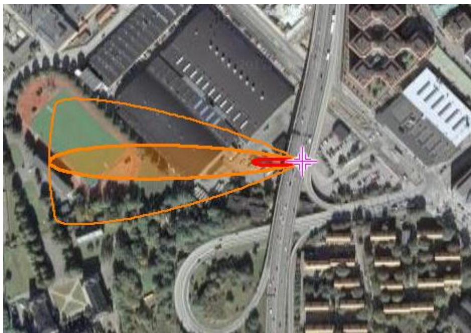
Figur 24. Resultat från utförda spridningsberäkningar av ett utsläpp av tryckkondenserad ammoniak, brott på rör (medelstort utsläpp). Röd zon (10 x 60 m) åskådliggör ytor utomhus där människor efter 5 minuters exponering kan omkomma medan orange zon (40 x 300 m) åskådliggör ytor utomhus där människor efter 5 minuters exponering kan förväntas behöva akut vård.
