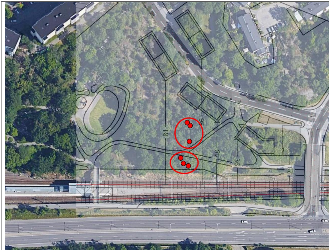
Figur 2. Mätpunkter markerade i rött. Ringarna avser 2 mätomgångar (alla 6 punkter mäts ej samtidigt). Tågen accelererar generellt ut från stationen söderut och saktar in mot stationen norrut (gäller pendeltåg). Detta leder till att hänsyn bör tas för en viss ökning i vibrationshastighet pga högre hastighet längre bort åt höger från mätpunkterna.
