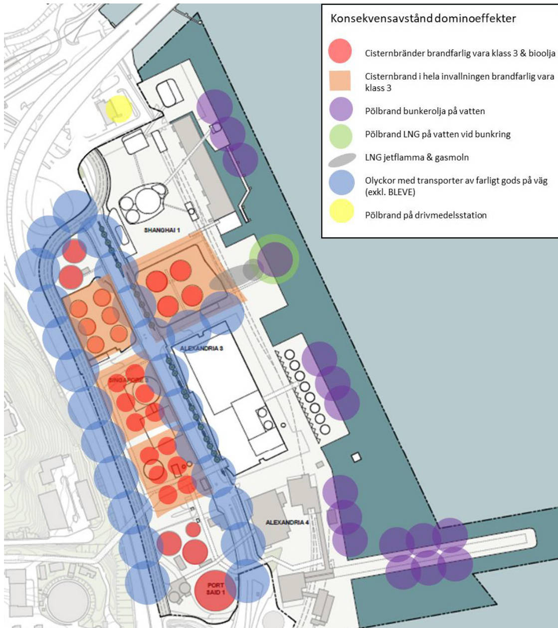
Figur 21. Konsekvensavstånd avseende händelser som kan medföra en dominoeffekt och sprida ett olycksförlopp till intilliggande system eller anläggningar, undantaget de minst sannolika typerna av explosioner (BLEVE). Placeringar principiella och exemplifierade. Redovisade konsekvensavstånd visar påverkan från respektive händelse oavsett om den initierats i sig själv (primär olycka/starthändelse) eller om den startat till följd av extern påverkan.
