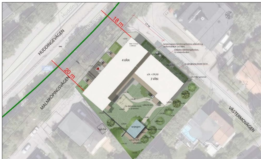
Figur 5. Situationsplan. Befintlig bullerskärm (träplank) mellan Huddingevägen och berört område är markerad med grön linje. I figuren framgår även de kortaste avstånden till Huddingevägen.
