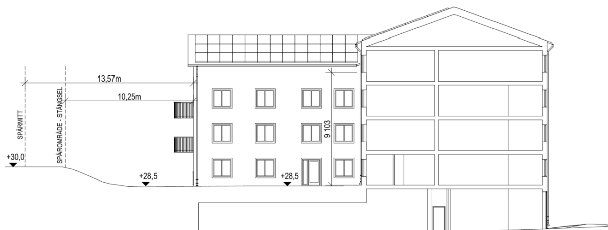
Figur 6. Sektion genom den del av byggnaden som ligger närmast tunnelbanan. Höjdförhållandet mellan spårområdet och marknivå vid den södra delen av byggnadsdel närmast spårområdet är 1,5 meter vilket framgår av figuren. (Liljewall arkitekter, 2023-11-13).
