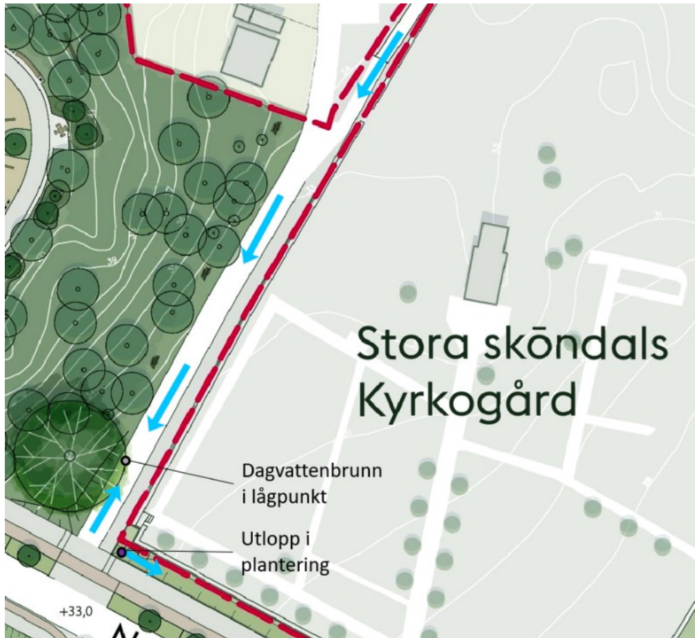
Figur 27. Föreslagen dagvattenhantering på Wilhelm Lindboms väg. Blå pilar indikerar dagvattnets planerade flödesriktning.
