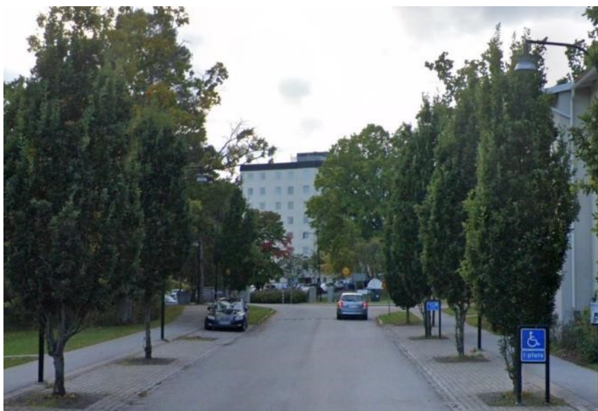
Figur 24. Befintlig utformning av Nils Lövgrens väg (från Google streetview) - dagvatten från vägytan når inte trädplanteringen.
