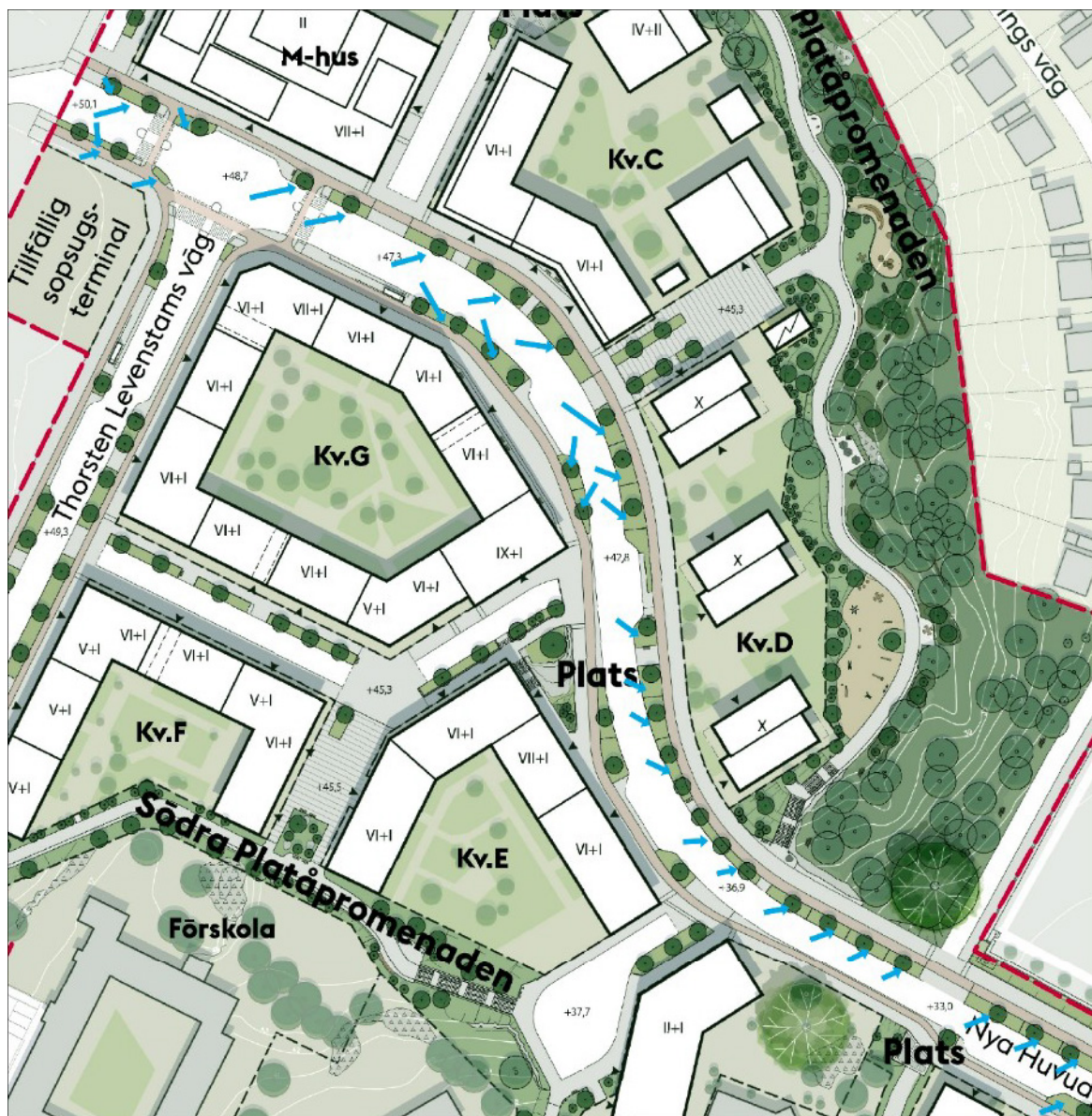
Figur 23. Föreslagen dagvattenhantering längs nya huvudgatan. Blå pilar indikerar dagvattnets planerade flödesriktning.
