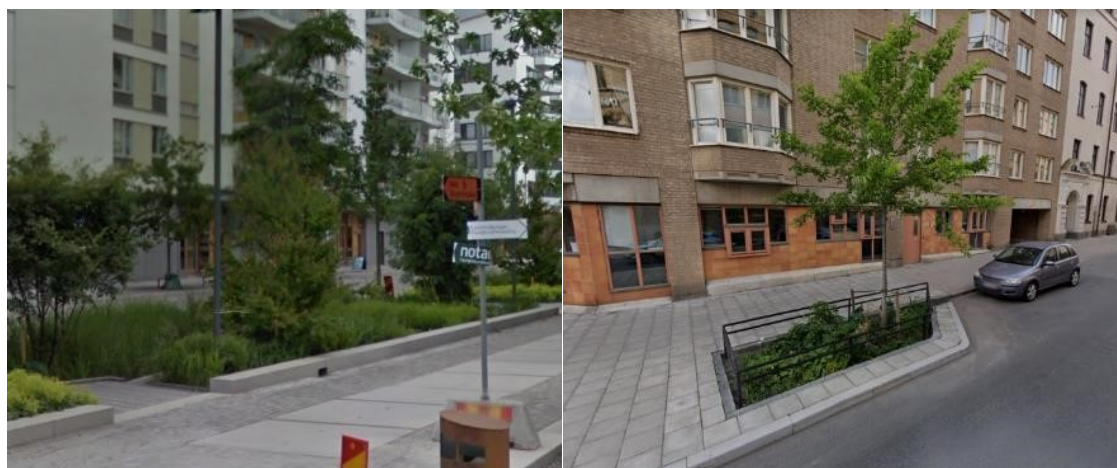
Figur 21. Lövängsvägen i Norra Djugårdsstan, nedsänkt och varierat grönt stråk i modern stadsmiljö. Rehnsgatan, växtbädd med släpp i kantsten i gatan för effektiv dagvattenhantering, från Google Streetview.
