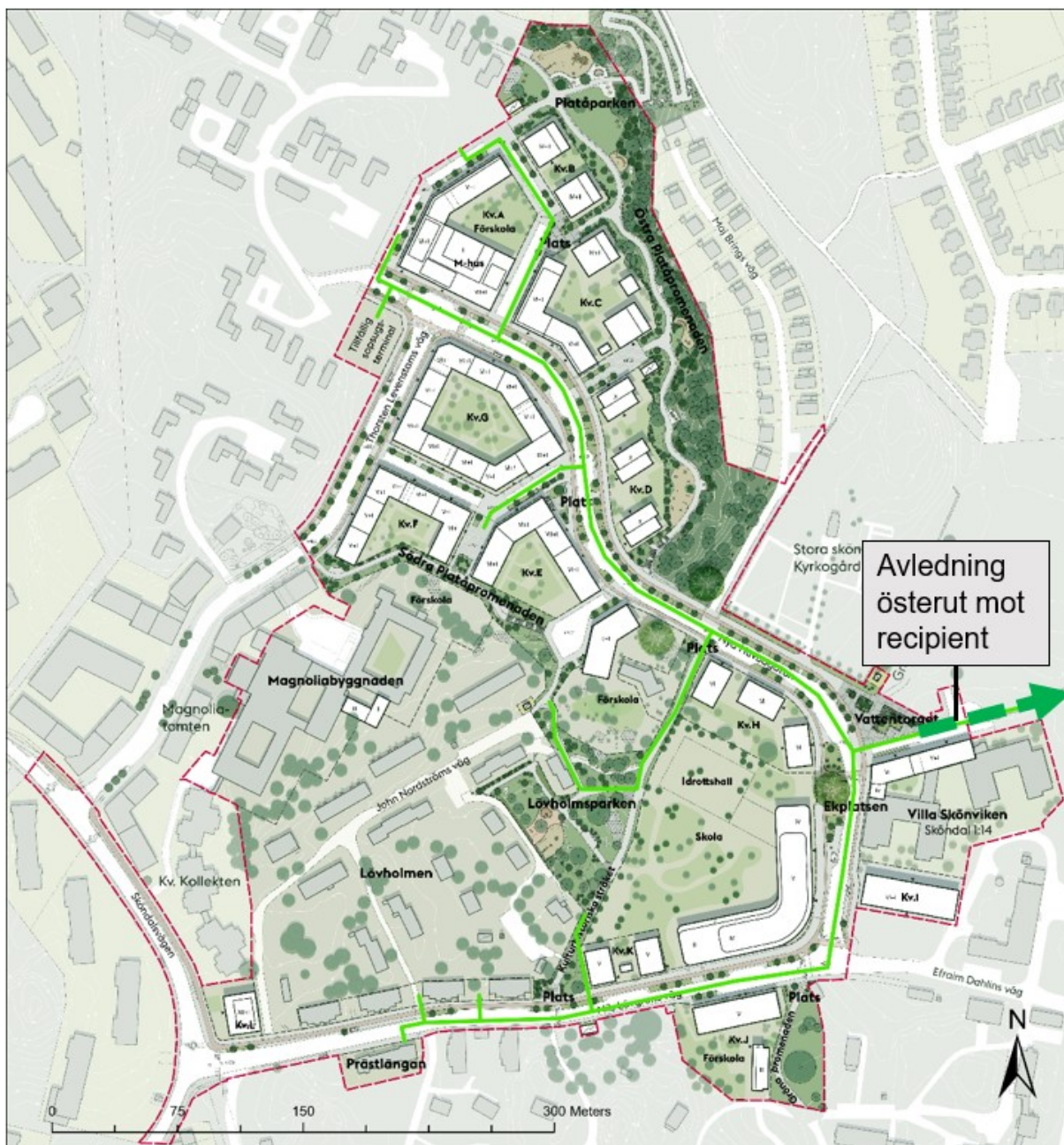
Figur 13. Planerat ledningsnät inom planområdet. Dagvattenledningen österut fortsätter utanför etappområdet till recipient, och följer samma sträckning som planerat skyfallsdike..
