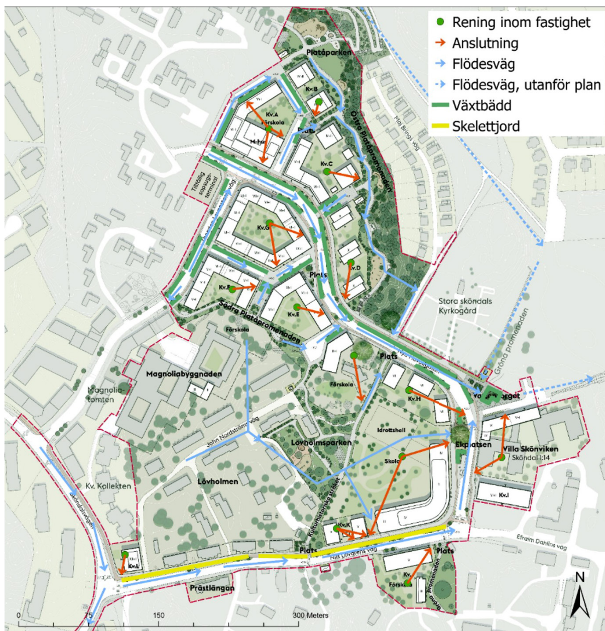
Figur 48 Översikt över flöden och hantering av dagvatten inom Etapp 2A. Redovisade dagvattenanslutningar avser önskemål från kvartersutredningar och utreds vidare vid detaljprojektering.
