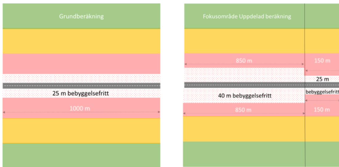
Figur 16. Förenklad modell av zoner och delar i uppdelad respektive grundberäkning.
