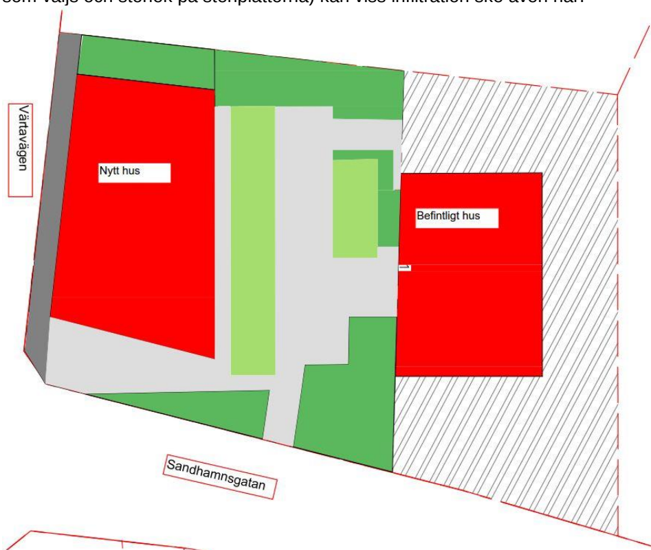
Figur 2. Röd streckad linje anger fastighetsgräns. Skräddarsydd yta, omgivande mark till det befintliga huset, samt befintligt hus har ej ingått i denna utredning. Ljusgröna ytor föreslås utgöras av gräsarmering och mörkgröna ytor av någon form av plantering enligt planförslaget. Grå yta föreslås stenbeläggas, ljusgrå med smågatsten och mörkgrå med betongplattor eller smågatsten.
