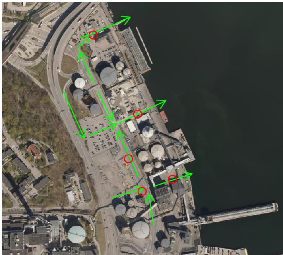
Figur 8. Schematisk skiss över befintliga kommunala dagvattenledningar och förbindelsepunkter för dagvatten. Figuren är ett utklipp från Sweco (2019). Gröna pilar markerar ledningsbunden avrinningsriktning och röda cirklar kommunala förbindelsepunkter för dagvatten för de olika fastigheterna i området.
