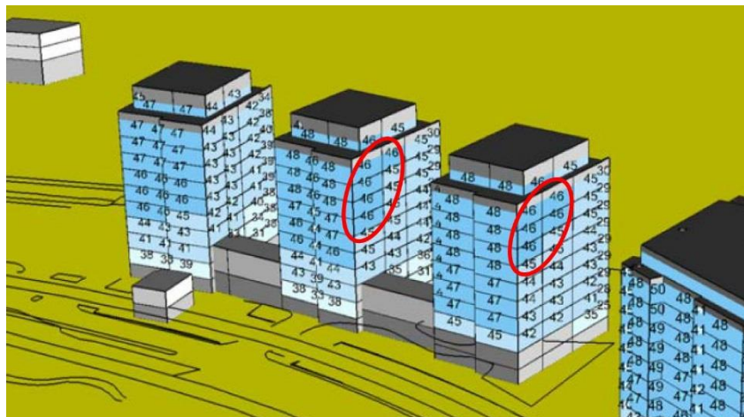
Masugnen 5. Beräknad markbullernivå kvällstid orsakad av Bromma Stockholm Airport. Inringade balkonger behöver förses med tätt balkongräcke för att riktvärden för markbuller ska uppfyllas.
