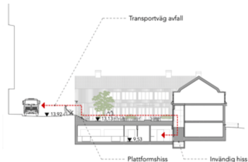
Sektion som visar avfallshanteringens flöde.
