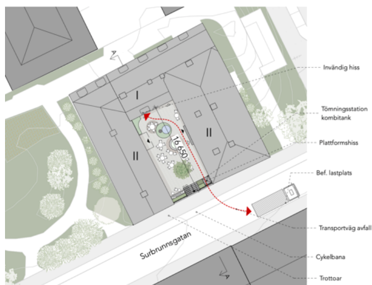
Situationsplan som visar avfallshanteringen.
