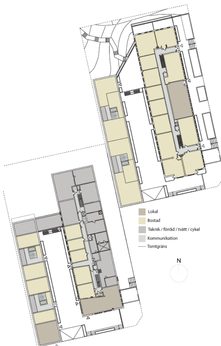
Planritningar som redovisar förslag till disponering av lokaler i plan 0 i nivå med gård (t.v.) och plan 1 i nivå med Sandhamnsgatan (t.h.).. Bild: Marge
