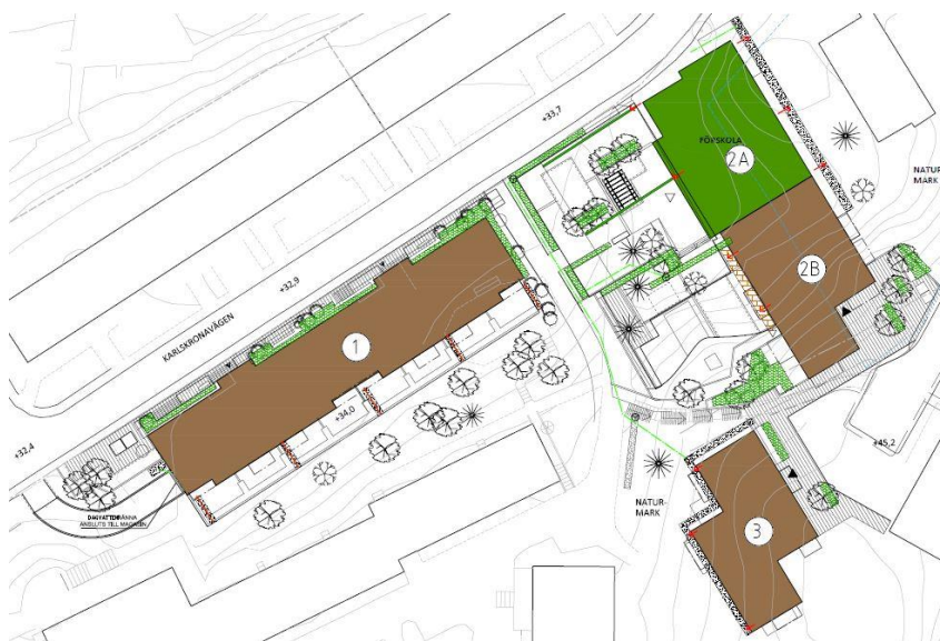
Förslag på dagvattenhantering. Detaljerad lösning med teckenförklaring framgår av bilaga i dagvattenutredningen. GREEN Mark & Dagvatten, 2018.
