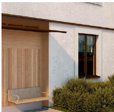
Sockelvåningen markeras med en plåtlist i samma kulör som övriga plåtdetaljer. (Bild White arkitekter)
