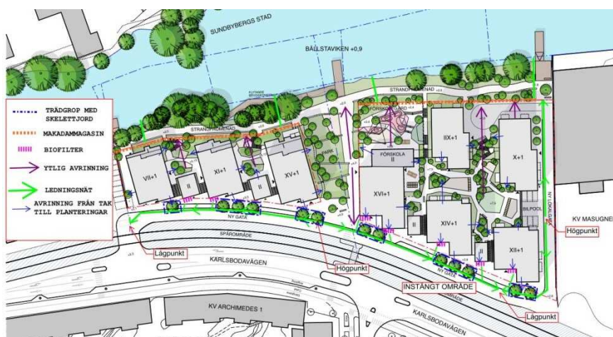
Dagvattenlösning som visar ledningsnät (grönt), ytlig avrinning (lila) samt trädgropar, biofilter och makadammagasin. WSP
