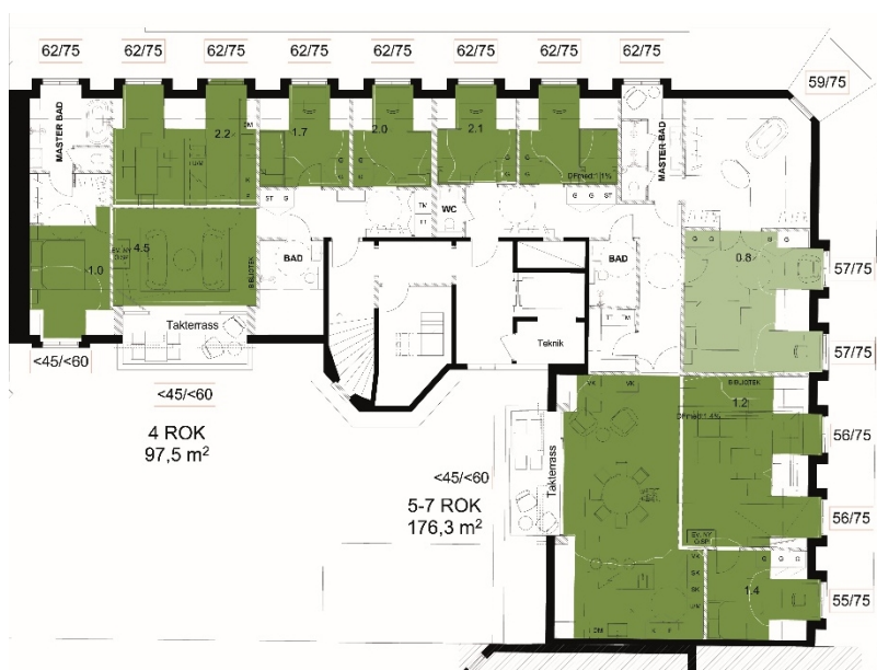
Figur 62 - Föreslagen planlösning vindsvåning (våning 5) med redovisade dagsljus- och bullerförhållanden (Strategisk Arkitektur, 2023).
