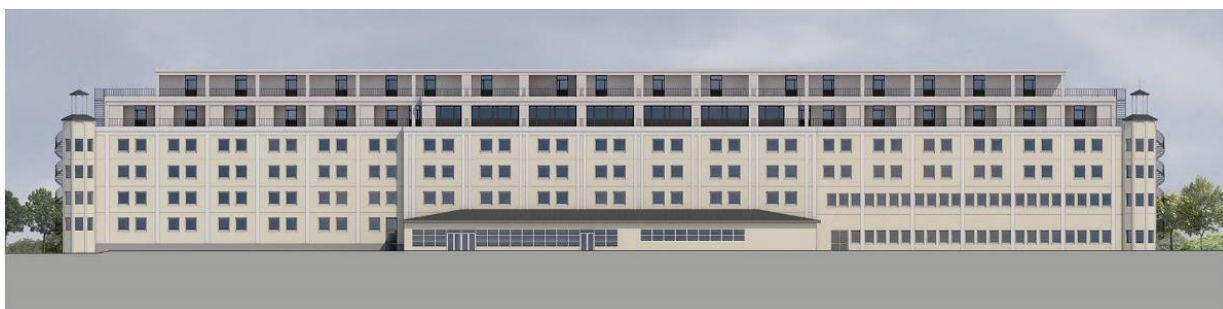
Påbyggnad: fasad mot gård. Element från hotellet – rytmer, pilastrar och lister – tas upp i form av linjespel i påbyggnadens fasad, medan material och kulör skiljer gammalt från nytt.
