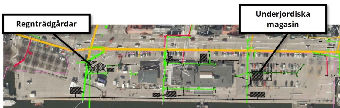
Förslag 1A för dagvattenhantering. Föreslagna lösningar består av svarta linjer. Befintliga ledningar är färgade linjer (Dämningsverket 2020).
