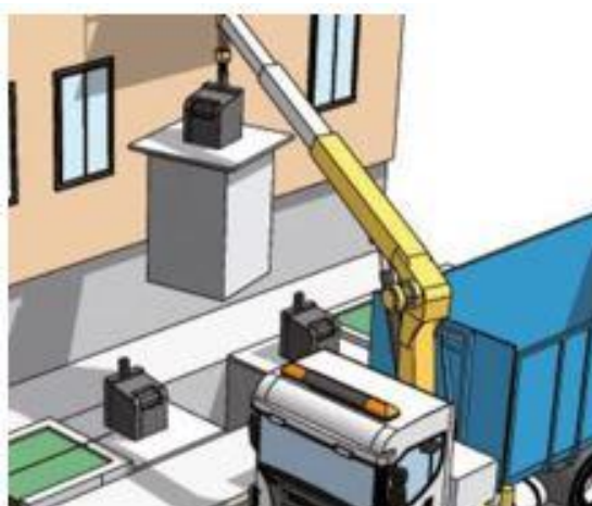
Exempel på sopkassun med nedsänkta behållare i marken.
