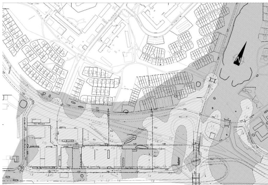
Geotekniska förhållanden. Mörk skraffering: Ungefärligt område med fastmark fyllning torrskorpa, friktionsjord och berg. Ljus skraffering: Ungefärligt område med lös lera
