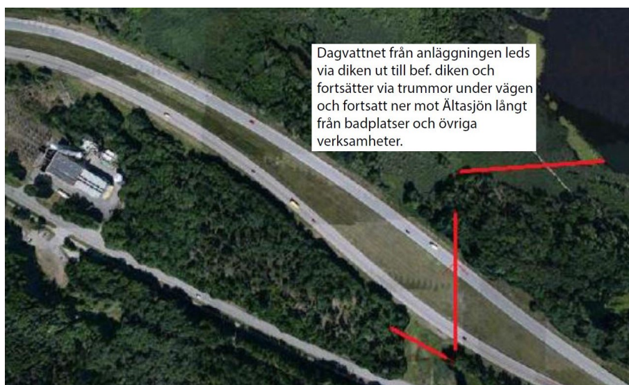
Bild från dagvattenutredningen (2018-02-06) som visar på avrinning från området. Sweco 2018.
