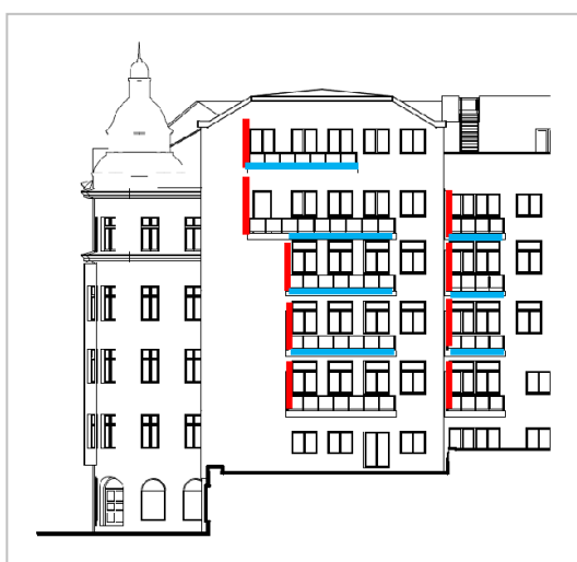
Bilden visar en del av fasaden i norr mot grannfastigheten Sandbacken Mindre 42. Röda streck avser täta skärmar av ex glas, blåa streck avser absorbenter.
