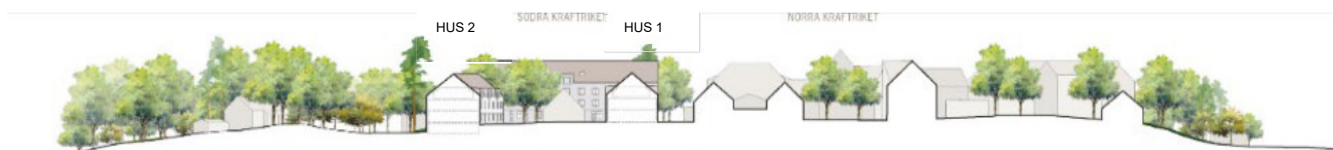
Sektion A-A', genom landskapet, hus 1- 2, huvudstråk och angränsande befintlig bebyggelse norr om planområdet. De nya byggnaderna möter upp taklandskapet i norra Kräfteriket och inordnar sig i det kuperade landskapet. Nockhöjder anpassas på samma vis som befintliga byggnader, strax under trädtopparna.
