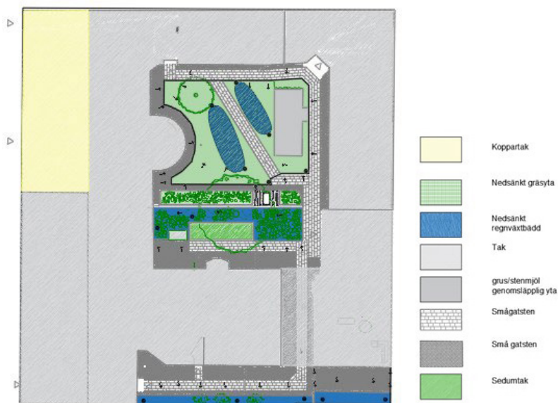
Förslag på placering av dagvattenanläggningar (ur dagvattenutredning, Nova Terra).
