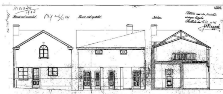
Utdrag av på- och tillbyggnadsritning av brygghuset/tvättstugan, 1924, med fönster och dörrar i trä. (ALX, 2021-03-25)
