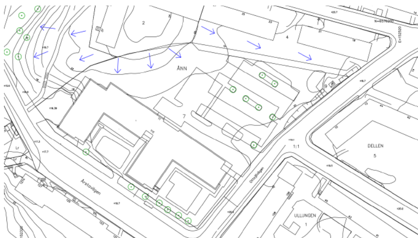
Bilden visar hur vattnet rinner idag. Bild: Novamark (från PM Dagvattenutredning, Nova Terra, 2020-10-12).
