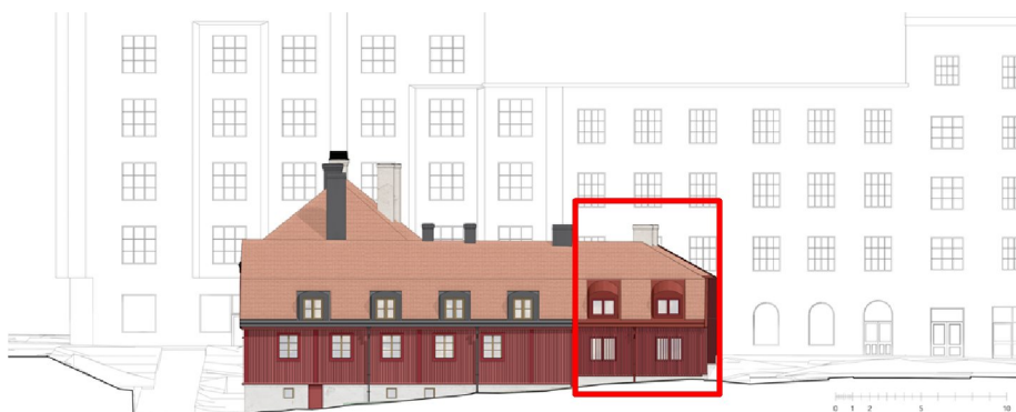
Sektion mot söder som visar hur flygelbyggnadens ansluter till den befintliga byggnadens mansardtak och takkupor. Tillkommande flygelbyggnad markerad med rött.
