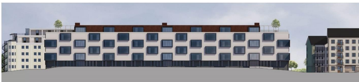
Nybyggnad: fasad mot E4/E20 Södertäljevägen. Fasad mot E4 ska utformas med inbyggd korridor med stora glaspartier. Takterrass med pergola och bullerskyddad glaspartier syns i bilden. Larsson Arkitektur AB.
