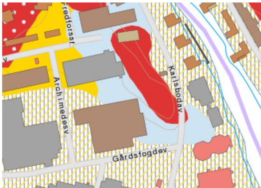
Jordartskarta från SGU, grå ränder är fyllning, sneda gula ränder är lera och silt, ljusblå fält är morän och rött är berg.
