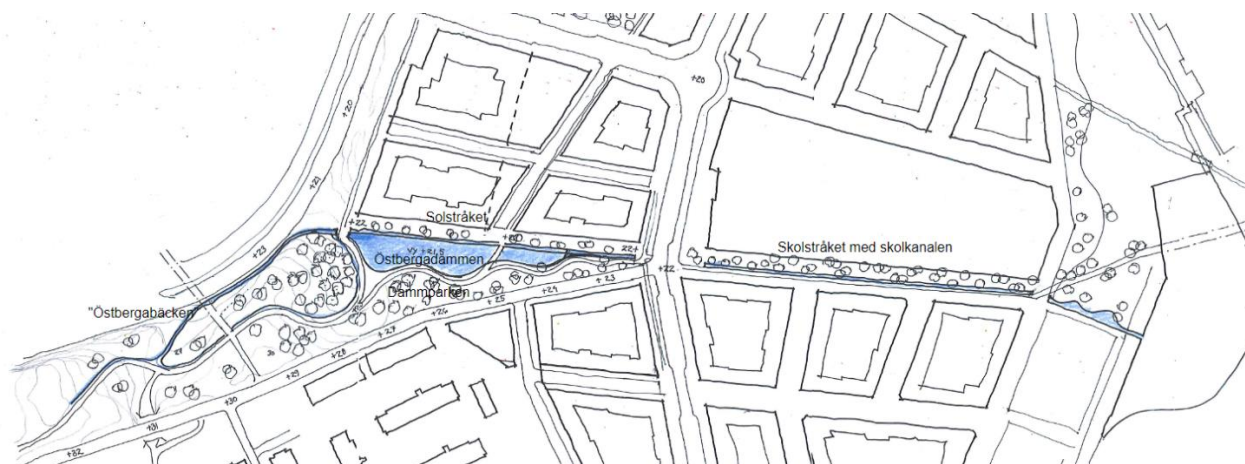
Östbergadammen (blå i bilden) fördröjer vatten vid skyfall innan det leds vidare till Skyfallsparken. Längs med södra skolgatan planeras ytor för dagvattenhantering. Härifrån rinner skyfall vidare till dammen i parken. Bild: White
