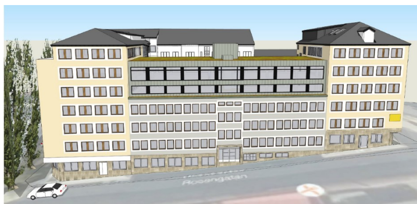
Bild som visar fasaden mot Rosengatan. De föreslagna fönstren på påbyggnaden är större men följer samma grundrytm som originalvåningarna under. Illustration Thule fastighetsutveckling.
