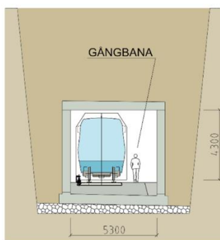
Normalsektioner för enkelspår i betongtunnel med gångbana respektive dubbelspår i betongtunnel med gångbana. Måtten i figurerna är angivna i millimeter.
