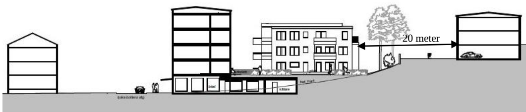
Sektion som visar avstånd och höjdskillnader mellan de nya husen och befintliga radhus på Mälarblick. Avståndet mellan det korta husets gavel och befintliga radhus är minst 20 meter. (Arkitekter Engstrand & Speek)
