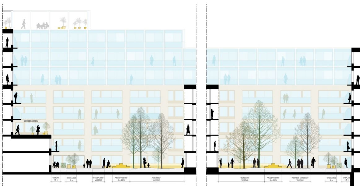
Principsektion innergård, sydväst-nordost genom det nya gårdshuset. Fojab.
