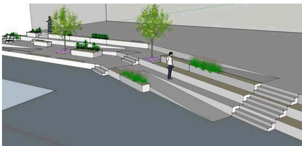
Idéskiss över uppbyggd sitt- och lekstruktur på gården, placerad i soligt läge i fastighetsgräns mot Blåstern 6. Konstruktionen tar upp nivåskillnaden mellan de bägge fastigheterna. Ramper sluttar max 1:12. Planteringar integreras i volymen.
