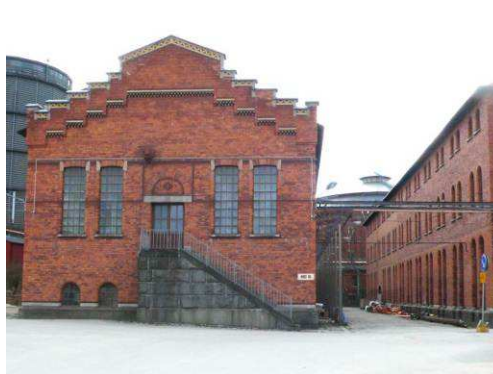
Trappan framför hus 10. Bilden visar även tegelfasader, tegelutsmyckning, stendetaljer och stenuksmyckning samt fönsteröppningar med bågar och karmar som ska bevaras enligt q8 ovan.
