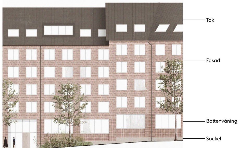
Princip om en fyrdelad ordning, med urskiljbara byggnadsdelar. Bild: Arrhov Frick.
