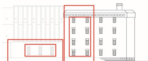
Enskede elverks nya fasad mot sydväst (genom gård). Fasaden friläggs och igenmurade fönster tas upp, nya fönster tillverkas motsvarande originalen.
