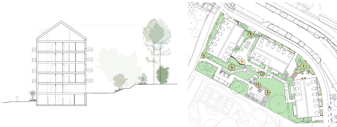
Till vänster sektion från gata, genom byggnad och genom gården för kv H som visar kvarterets topografi. Till höger illustrationsplan gård. Bild: Tengbom.
