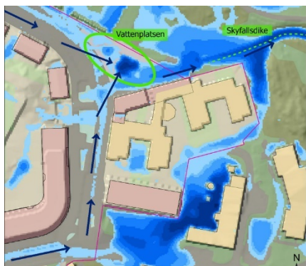
Princip för styrning av flöde bort från översvämningsdrabbat område kring Villa Skönviken.
