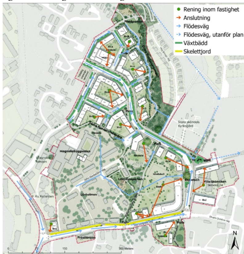
Översikt över flöden och hantering av dagvatten inom etappen. Ur Dagvattenutredning, WSP.
