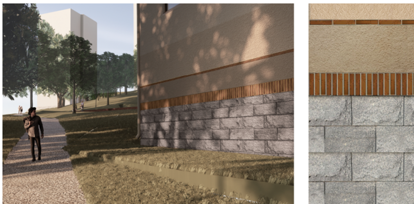
Vy och detalj av ny skolbyggnads sockel på fasad mot söder.
