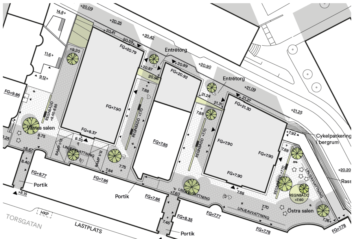
Förslag på höjsättning av gården för att säkerställa att skyfallsvatten kan ta sig ut genom befintliga portiker. Bild: Fojab
