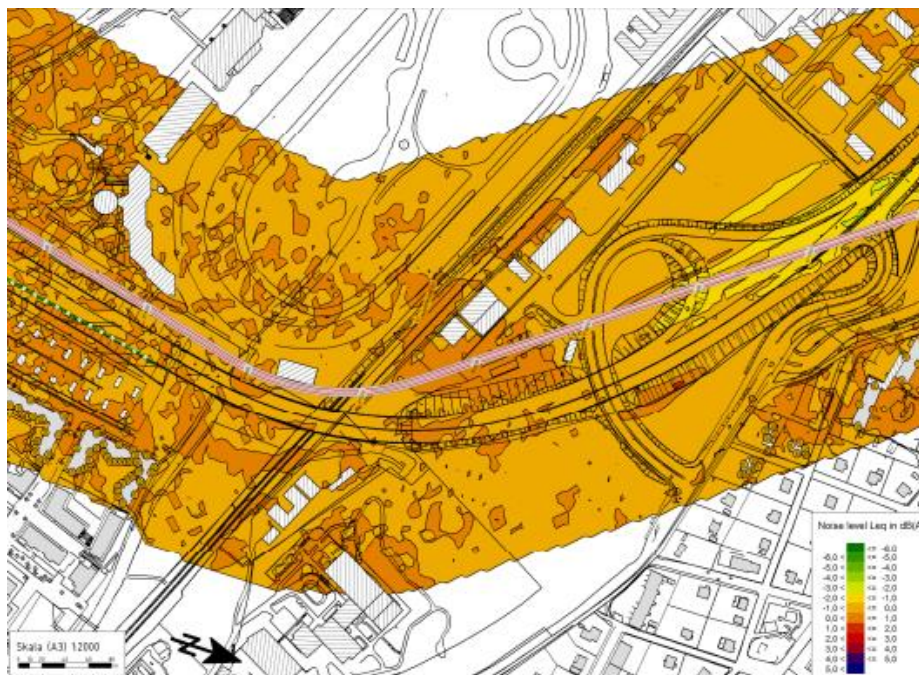
Bilden visar skillnad i buller mellan en betongbro och en samverkansbro (uppdateras med senaste jämförelsen).
