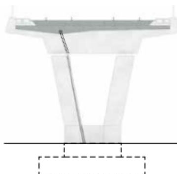
Princip för betongbro på stöd; sektion och perspektiv
